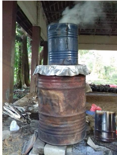
Gambar 5. Menutup rapat, sehingga diusahakan tidak ada oksigen (pirolisis sederhana).
