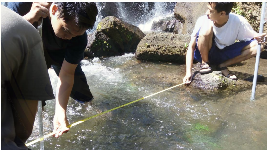
Gambar G.2 Pengukuran kedalaman air menggunakan penggaris 1 meter
