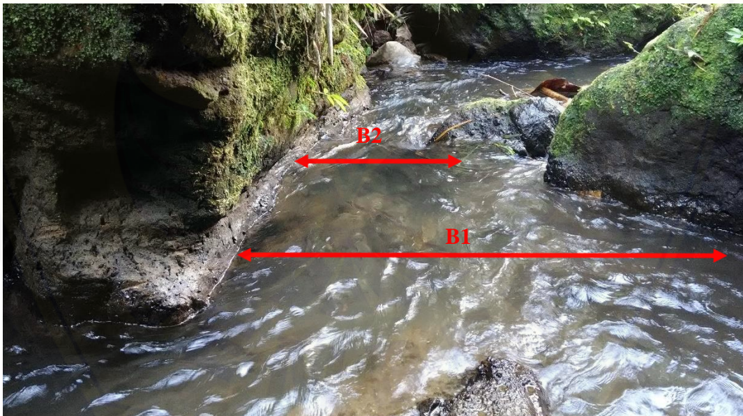
Gambar B.1 Area pengukuran luas penampang B
