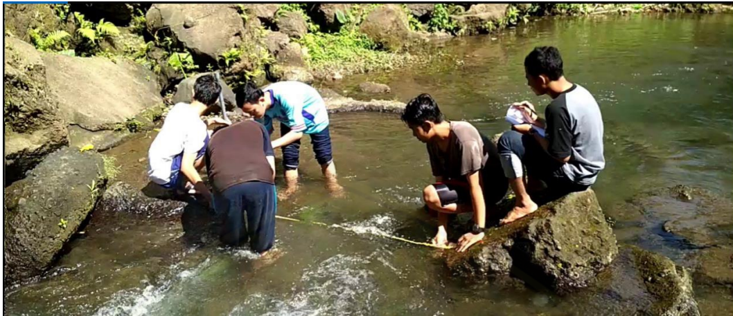
Gambar G.3 Pengukuran lebar penampang aliran menggunakan meteran
