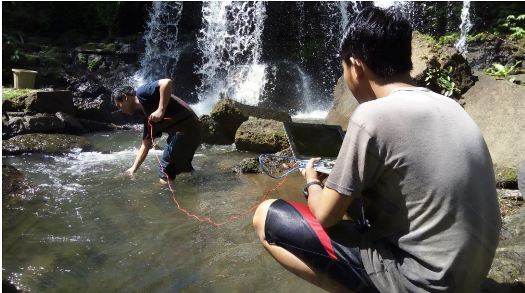
Gambar G.1 Pengukuran kecepatan aliran air menggunakan sensor flow rate
