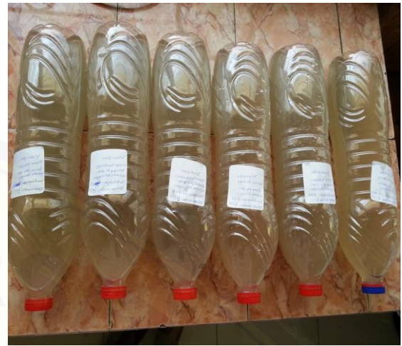
Gambar 10. Mengontakkan serbuk cangkang telur dengan limbah elektroplating selama 90 menit
