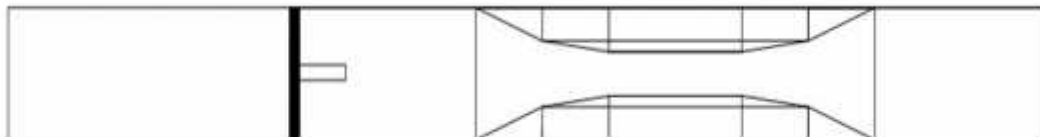
Gambar 3.3 Desain tampak atas pada tabung hidrolik dengan penyempitan ketebalan 2 cm di kanan dan kiri.
