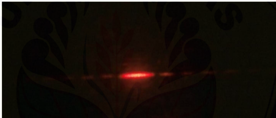
Pola difraksi sinar laser He Ne saat melalui udara
