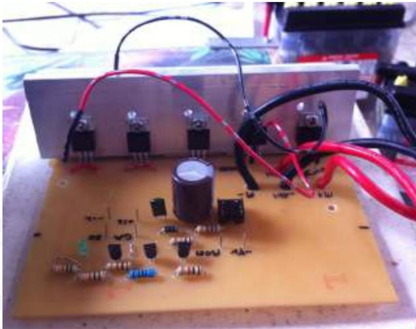
Gambar 3.9 *Board* Rangkaian *Driver* Penggerak Konveyor
