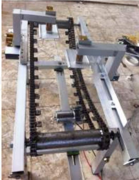
Gambar 3.3. Rangka alumunium Konveyor
