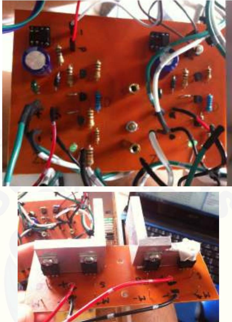
Gambar 3.11. Rangkaian *Driver* Motor Pisau Pemotong
