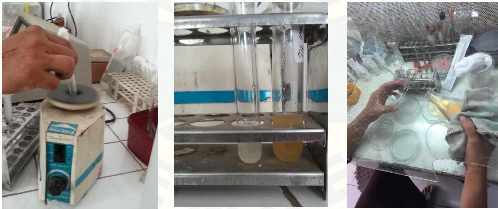
Gambar E.4 Suspensi jamur yang telah dibuat dihomogenkan menggunakan thermolyne . Media agar yang tadi sudah dibuat lalu dimasukkan ke dalam petridish setinggi 5 mm yang sebelumnya sudah dilabeli menurut kelompok perlakuan.
