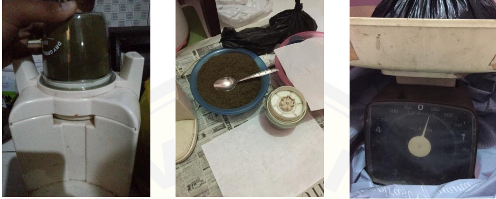
Gambar E.1 Daun kopi robusta yang sudah kering dan dipotong kecil diblender kemudian disaring untuk diambil serbuk halusanya. Setelah itu ditimbang sebanyak 277 gr.
