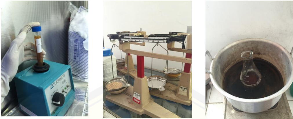
Gambar E.3 Hasil pengenceran konsentrasi ekstrak kemudian di mixing vortex agar homogen. Timbang bubuk SDA 15 gr dan dicampurkan dengan 300 mL aquadest lalu dipanaskan di dalam panci yg berisi air dan diaduk terus menerus agar homogen. Disterilkan menggunakan autoclave 121° C selama 15 menit dan dibiarkan dingin hingga mencapai suhu 50° C.
