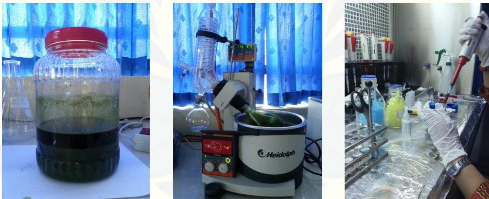
Gambar E.2 Serbuk dimasukkan toples dan dicampur dengan ethanol 96% sebanyak 1500 mL. setelah itu, rendaman diaduk menggunakan spatula dan ditutup rapat. Rendaman didiamkan selama 24 jam, kemudian dishaker di atas shaker digital rpm 50. Ampas dan filtrat dipisah menggunakan kertas saring dan ditampung dengan erlemeyer (lakukan remaserasi dengan ethanol 96% sebanyak 1250 mL seperti diatas). Hasil ekstrak diuapkan dengan rotary evaporator selama 3 jam 30 menit dan akhirnya proses ekstrasi selesai dilanjutkan dengan pengenceran konsentrasi ekstrak dengan DMSO 1%.
