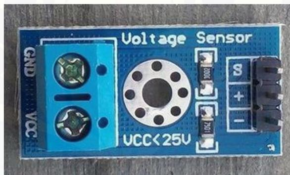
Gambar 2.6 Sensor Tegangan
