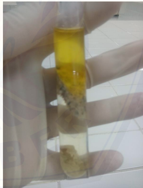
Gambar B.3 Minyak ikan lemuru setelah disentrifuge akan terpisah dari air dan lemak
