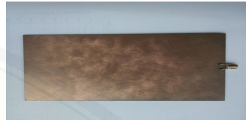
Gambar 12. Antena Mikrostrip meander-line tampak belakang
