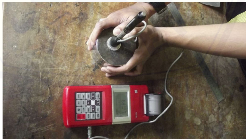
Gambar 3.9 Proses pengukuran kekerasan permukaan dentin gigi dengan menggunakan alat uji kekerasan elektrik (Time Hardness Tester, TH120).
