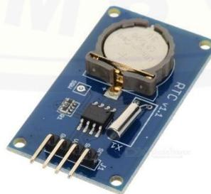
Gambar 2.21 Modul *Real Time Clock ( RTC )* DS1307
