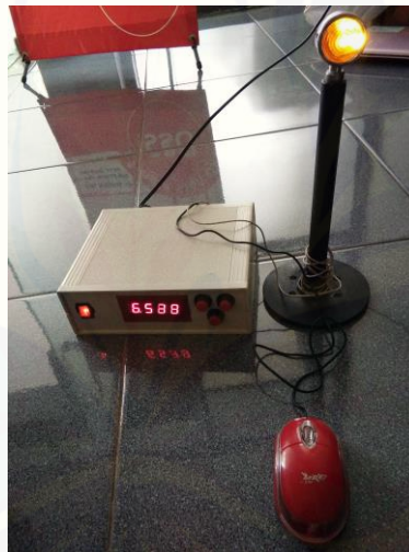
Gambar 3.2 Alat Ukur Kelelahan Mata ( Reaction Timer ) Sumber : Dokumen pribadi
