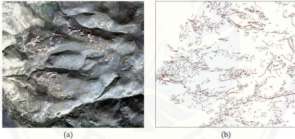
Gambar 2.10 Hasil ekstraksi lineament pada area tambang di Gölbası, Ankara, Turki: (a) Citra RGB Ikonos; (b) Hasil ekstraksi lineament secara manual (Kocal, Duzgun, & Karpuz, 2012).
