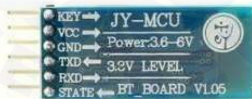
Gambar 2.12 Konfigurasi Pin Modul Bluetooth HC-05 (Sumber: eprints.polsri.ac.id)
