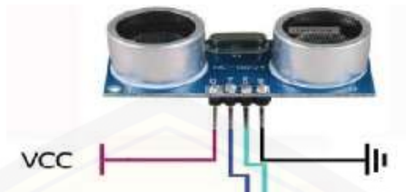
Gambar 2.7 Tampilan Sensor ultrasonik HC-SR04 (Sumber: Setiawan dkk, 2014)
