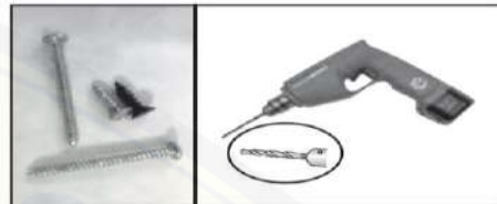
Uliran pada sekrup dan bor memanfaatkan prinsip bidang miring
