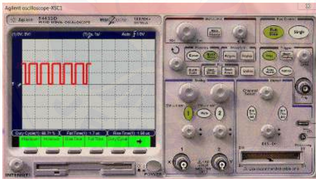
Gambar 4.1.2 Output duty-cycle, fall-time dan rise-time dari hasil simulasi rancangan rangkaian generator pulsa tegangan rendah bagian pertama
