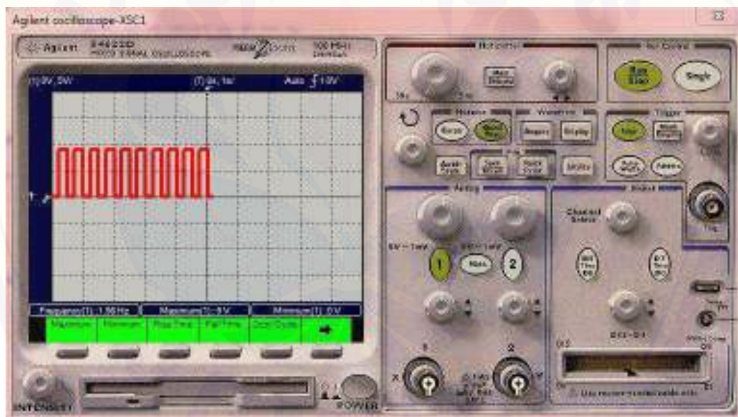
Gambar 4.1.6 Output tegangan maksimum ( V_{max} ) dan tegangan minimum ( V_{min} ) dari hasil simulasi rancangan rangkaian generator pulsa tegangan rendah bagian kedua
