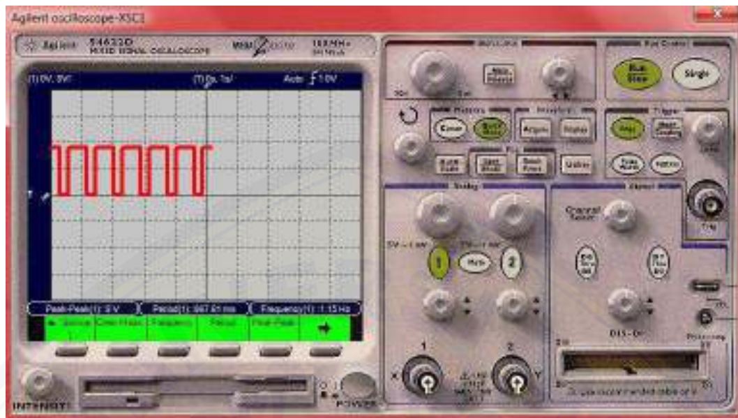
Gambar 4.1.1 Output tegangan puncak ke puncak ( V_{pp} ), periode dan frekuensi dari hasil simulasi rancangan rangkaian generator pulsa tegangan rendah bagian pertama
