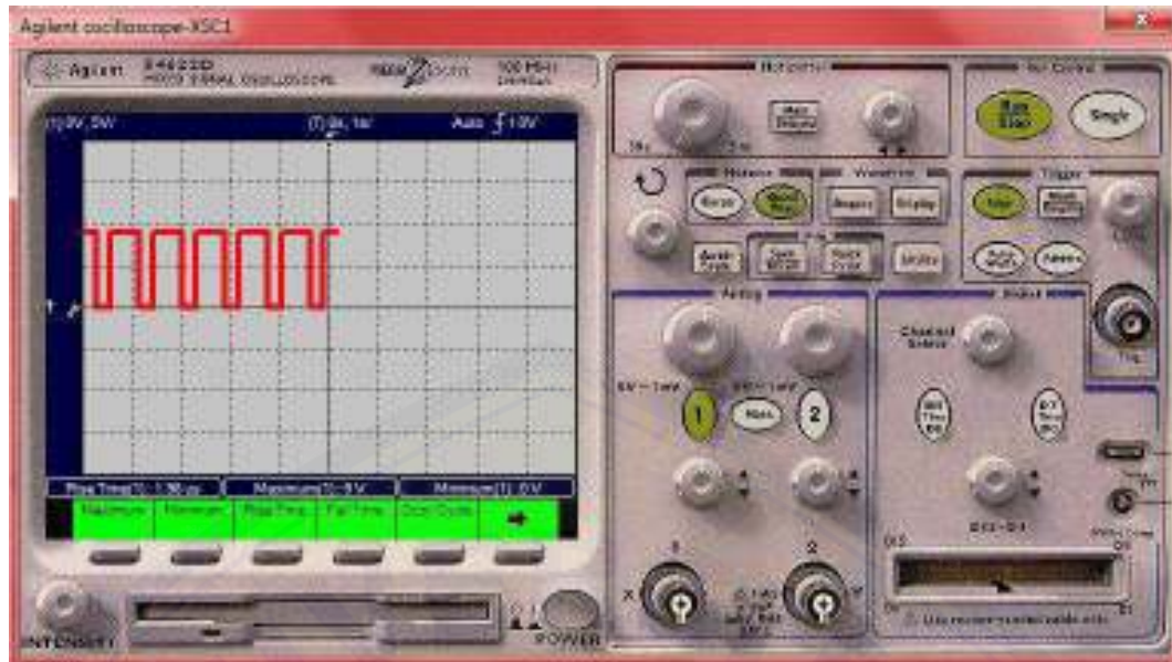
Gambar 4.1.3 Output tegangan maksimum ( V_{max} ) dan tegangan minimum ( V_{min} ) dari hasil simulasi rancangan rangkaian generator pulsa tegangan rendah bagian pertama
