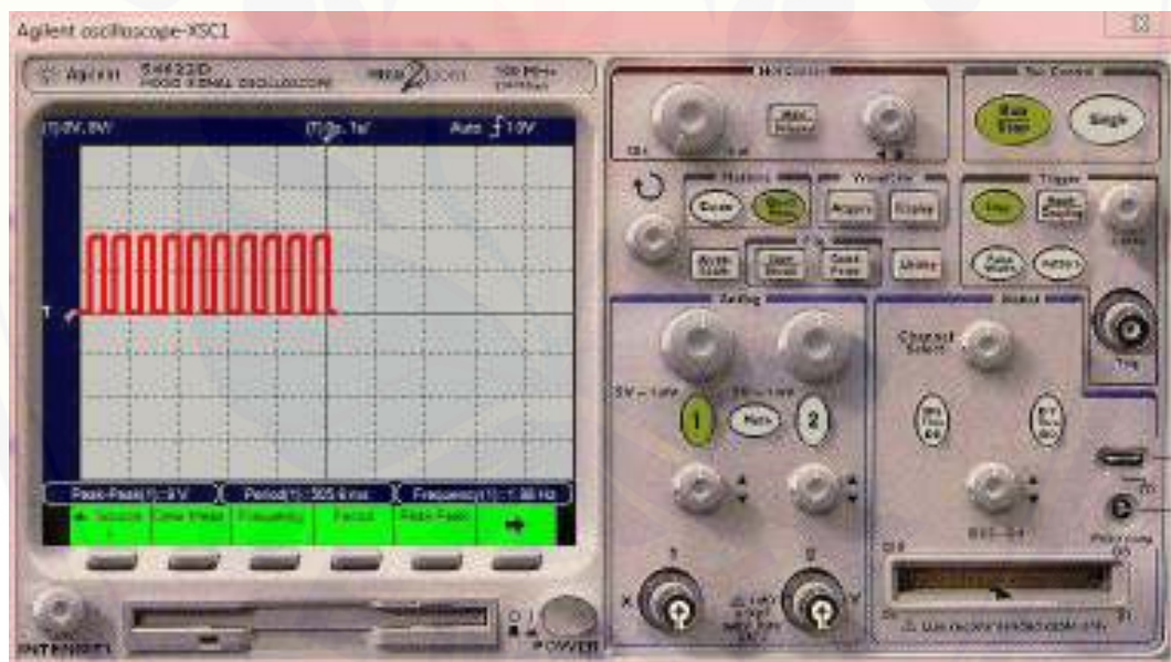
Gambar 4.1.4 Output tegangan puncak ke puncak ( V_{pp} ), periode dan frekuensi dari hasil simulasi rancangan rangkaian generator pulsa tegangan rendah bagian kedua
