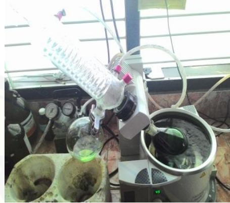
Pemekatan ekstrak dengan Rotary evaporator
