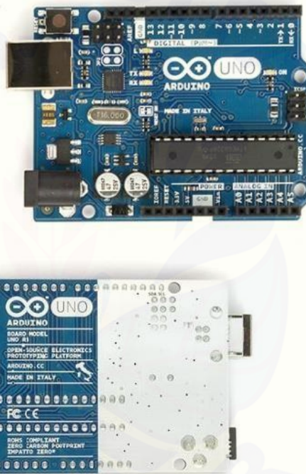
Gambar 2.2 Arduino uno R3 bagian depan dan belakang
