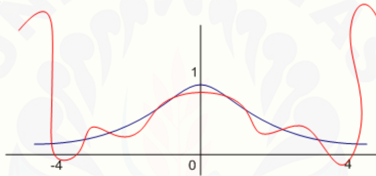
Gambar 2.3 Interpolasi terhadap f(x) = \frac{1}{1+x^2} pada interval [-4,4]
