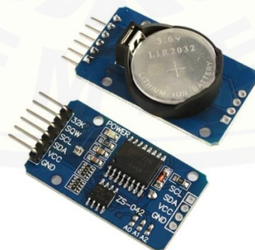
Gambar 2.6 Bentuk Fisik Modul RTC DS3231 (Sumber : https://chioszrobots.com/2014/03/19/ds3231 )
