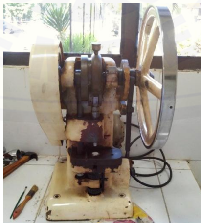
Pembuatan tablet dengan pencetak tablet single punch
