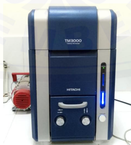
Karakterisasi morfologi dan ukuran microspheres dengan SEM
