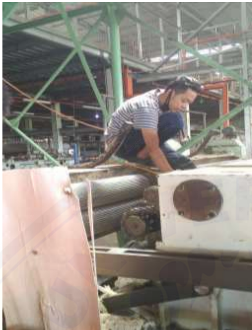
Gambar 5. Pekerja melakukan perawatan pada mesin saat mesin menyala
