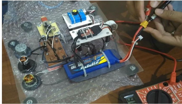
Gambar 3. Pengujian tegangan pada baterai Li-Po Zippy Flightmax 1800 mAh 2S / 7,4 V 20 C menggunakan multimeter
