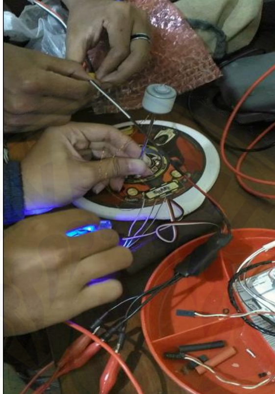
Gambar 1. Pengujian motor BLDC tiga fasa sensorless dengan tipe konstruksi out-runner
