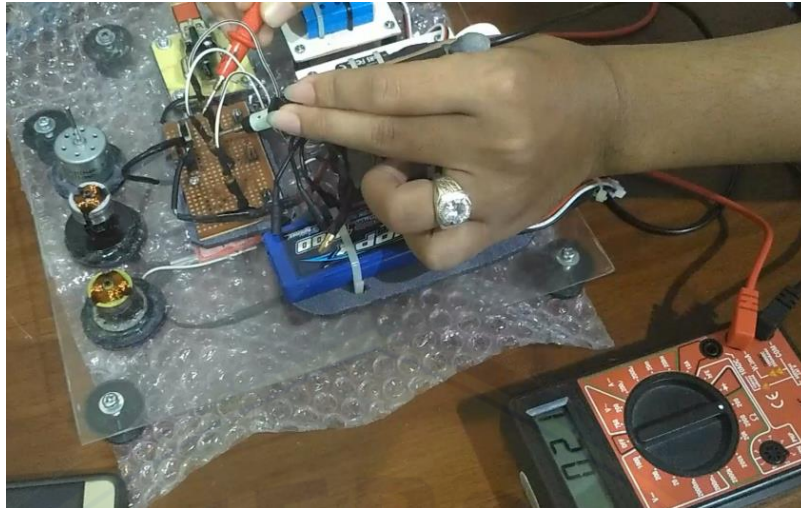
Gambar 6. Pengujian resistansi kawat tembaga pada stator kedua dengan jumlah lilitan sebesar 100 lilit menggunakan multimeter
