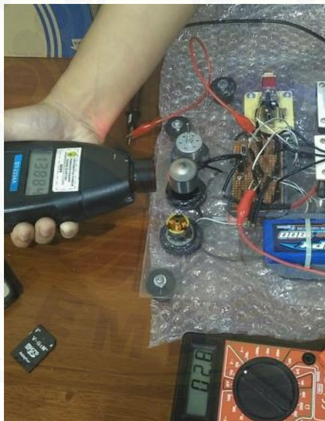
Gambar 7. Pengujian kecepatan motor BLDC 3 fasa sensorless dengan jumlah lilitan sebesar 100 lilit menggunakan tachometer
