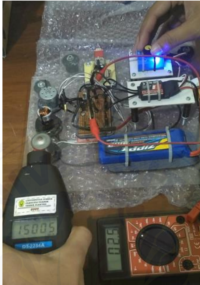
Gambar 8. Pengujian kecepatan motor BLDC 3 fasa sensorless dengan jumlah lilitan sebesar 150 lilit menggunakan tachometer
