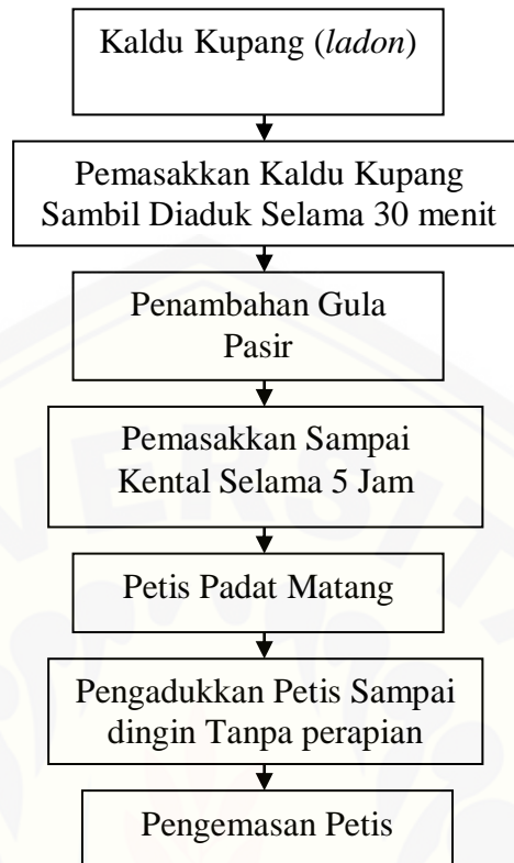
Gambar 4.2 Skema Proses Pembuatan Petis Kupang
