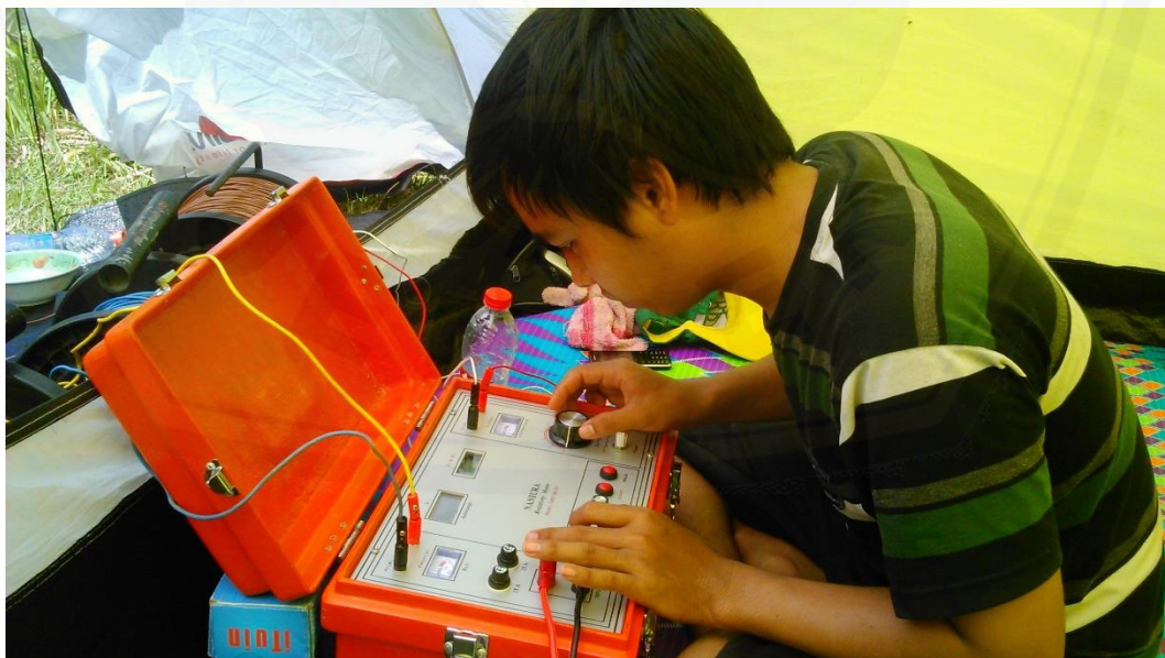
Gambar 11. Pengambilan data resistivitas
