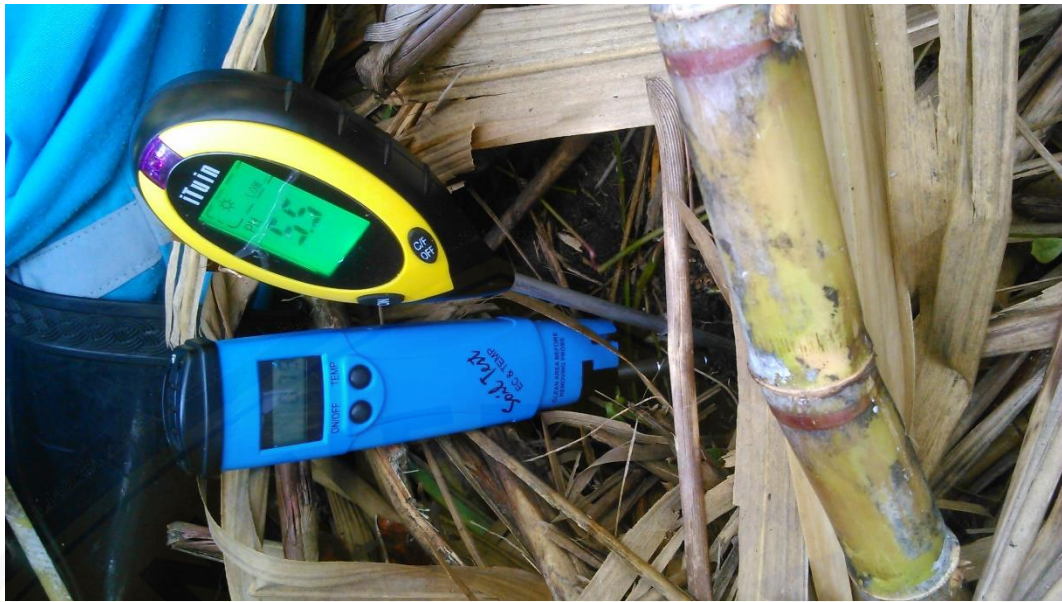
Gambar 12. Pengambilan data konduktivitas permukaan dan pH tanah
