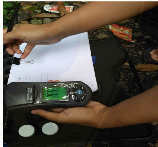
Gambar 16. Pengukuran Kekeruhan Air dengan Turbidity Meter
