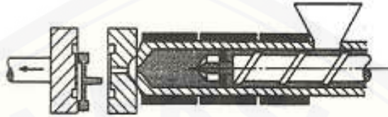
Gambar 2.6 Proses Membukanya Cetakan (Bambang, 2011)
