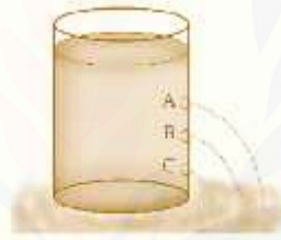
Pancaran air dalam tabung yang diberi tiga lubang
