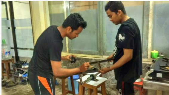
Gambar C.2 Proses Pemberian Cat Pada Rangka
