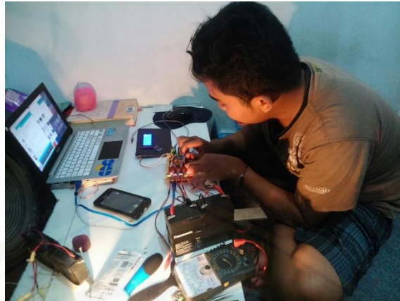
Gambar C.4 Proses Pemasangan Sensor Pada Datalogger
