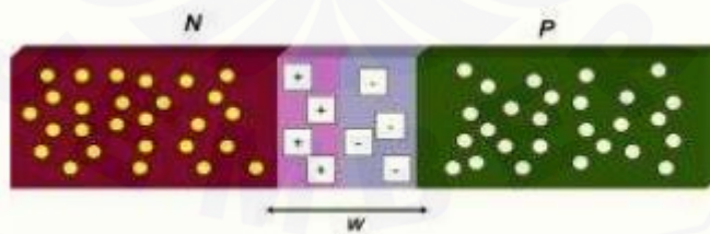
Gambar 2.9 Daerah Depleksi Pada PN Junction
