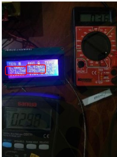
Kalibrasi sensor arus INA219
