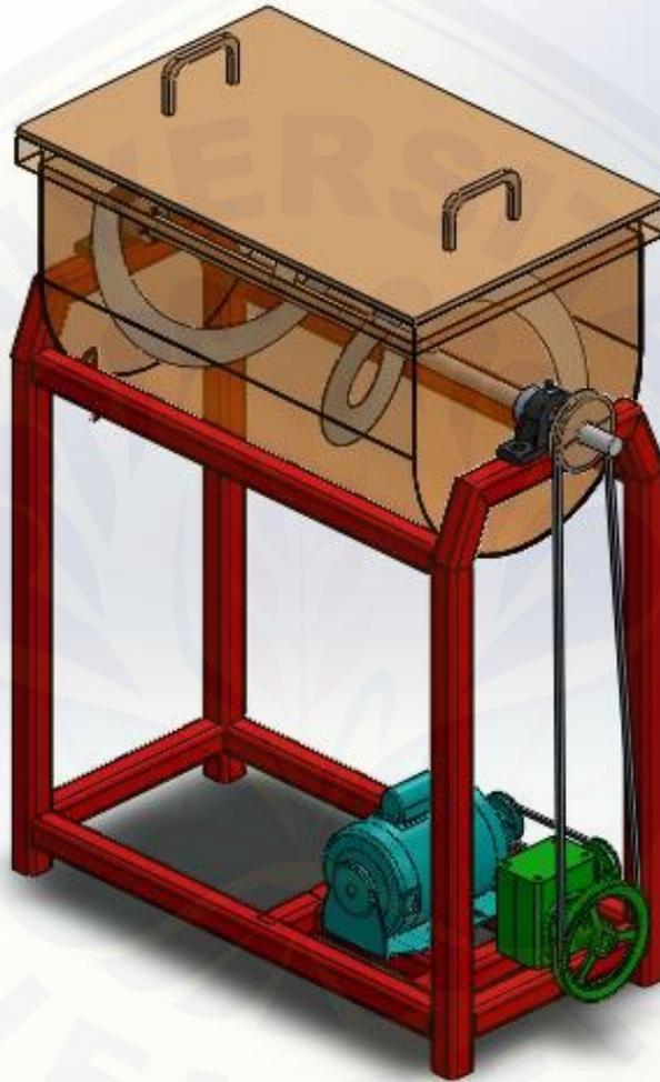
Gambar C.1 Gambar Mesin Pengaduk Adonan Briket
