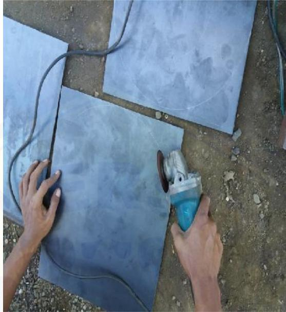
Gambar C.4 Proses pemotongan plat untuk box
