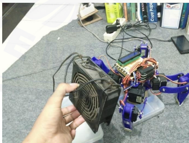
Gambar A.6 Proses Pendinginan Motor Servo Pada Robot Quadruped
