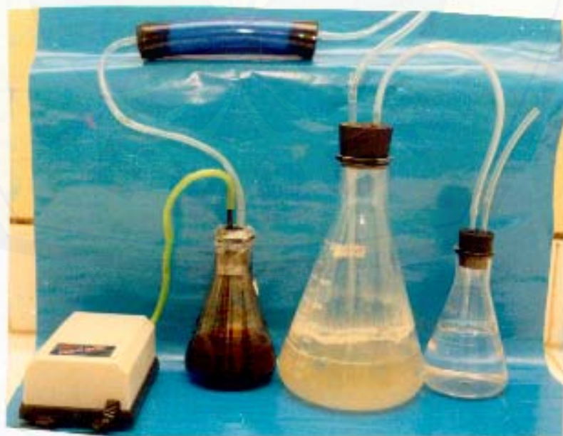
Gambar 2. Rangkaian Fermentor Sangat Sederhana (FSS)
