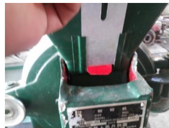
Gambar 4. Mengatur turunnya bahan ke dalam disk mill
