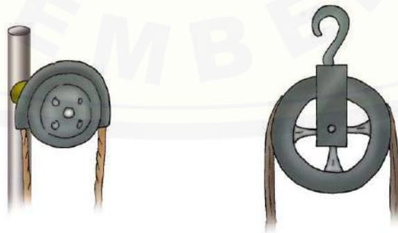
**Gambar 7.** Contoh penggunaan katrol tetap: (a) katrol pada tiang bendera, (b) katrol pada sumur timba
