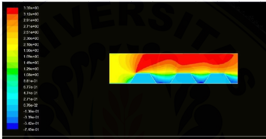
Gambar 2.12 Kontur ( velocity ) dengan Kecepatan Angin 2 m/s.
