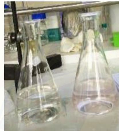
Gambar 9. Perubahan warna menjadi merah muda saat titrasi penentuan kadar asam lemak bebas
