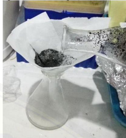
Gambar 7. Penyaringan untuk mengambil airnya untuk di uji kadar bilangan asam
