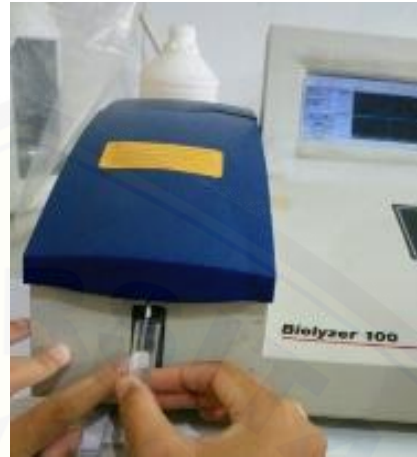
Gambar 14. Pengujian menggunakan alat Biolyzer untuk menentukan kadar kolesterol total, kadar kolesterol-HDL. Kadar Trigliserida
