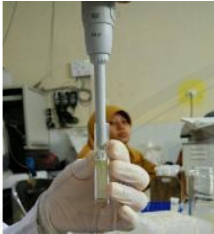
Gambar 13. Mencampur serum menciit dengan reagen kolesterol, HDL, dan Trigliserida sebelum di uji menggunakan alat Biolyzer
