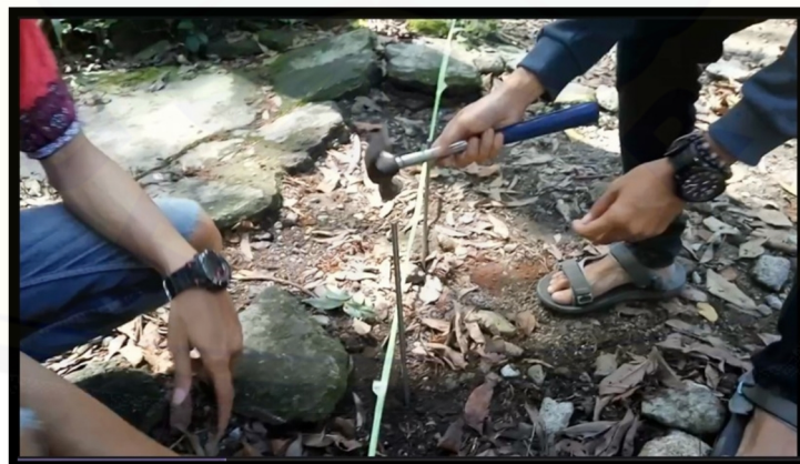
Gambar A. 8 Proses penancapan elektroda kedalam tanah
