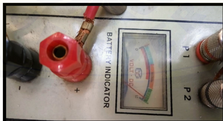
Gambar A. 11 Battery indicator pada warna hijau menunjukkan bahwa sumber tenaga untuk alat masih dalam keadaan penuh
