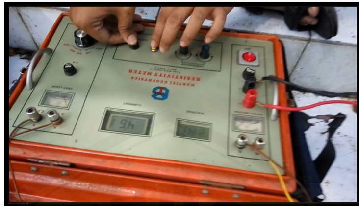
Gambar A. 9 Proses pemberian arus dengan menekan tombol current test
