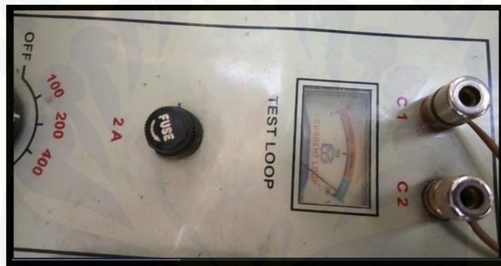
Gambar A. 10 Indikator pada test loop berada pada warna hijau yang menunjukkan bahwa pemberian arus dapat dilakukan
