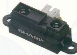
Gambar 2.5 Sensor Sharp GP2Y0A41SK0F (Sumber : Sharp, Tanpa Tahun)
