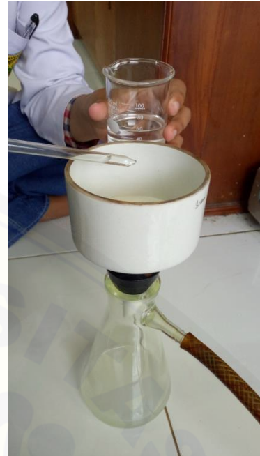
Pencucian microspheres dengan petroleum eter
