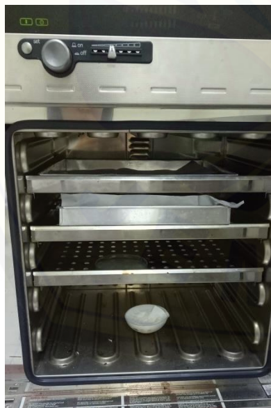
Pengeringan microspheres dengan oven
