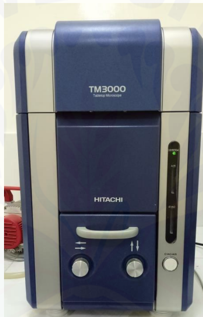
Karakterisasi morfologi dan ukuran microspheres dengan SEM
