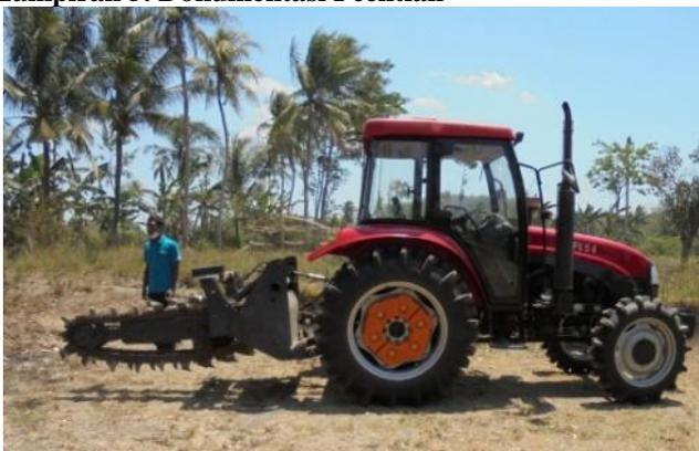
Gambar 1. Trencher dan Traktor Roda Empat
