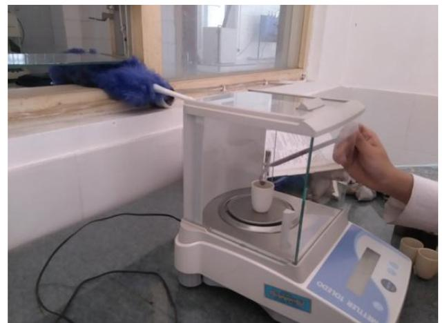
Gambar 4. Penimbangan Sempel Tanah Basah
