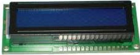
Gambar 2.21 LCD 16x2
