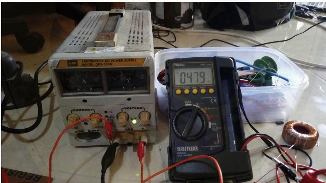
Gambar Pengujian *Output* Tegangan pada rangkaian *Boost Converter*
