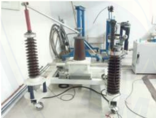
Peralatan Pembangkit Tegangan Tinggi
