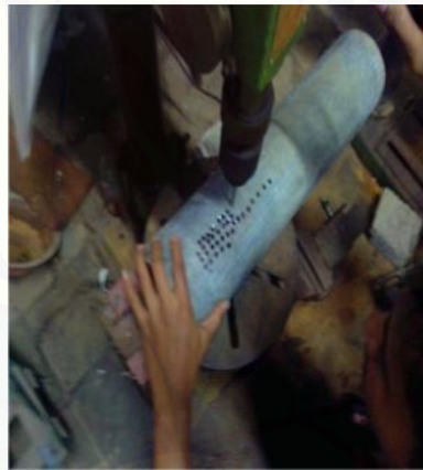
Gambar C.2 Pengeboran untuk membuat sarangan
