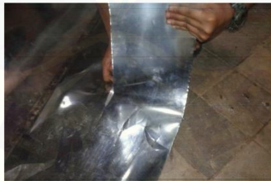
Gambar C.11 Pemotongan hopper keluar
