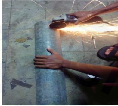
C.1 Pemotongan untuk rumah hopper
