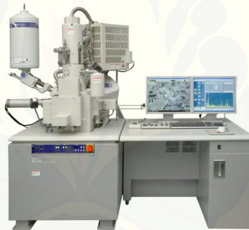
Gambar 2.6 Mesin alat uji SEM untuk mengetahui bentuk morfologi nanopartikel.
