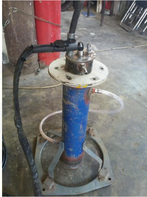
Gambar 3.3 : Reaktor Mesin DC thermal plasma
