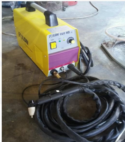
Gambar 3.2 : Mesin DC thermal plasma Rilon Cut 40
