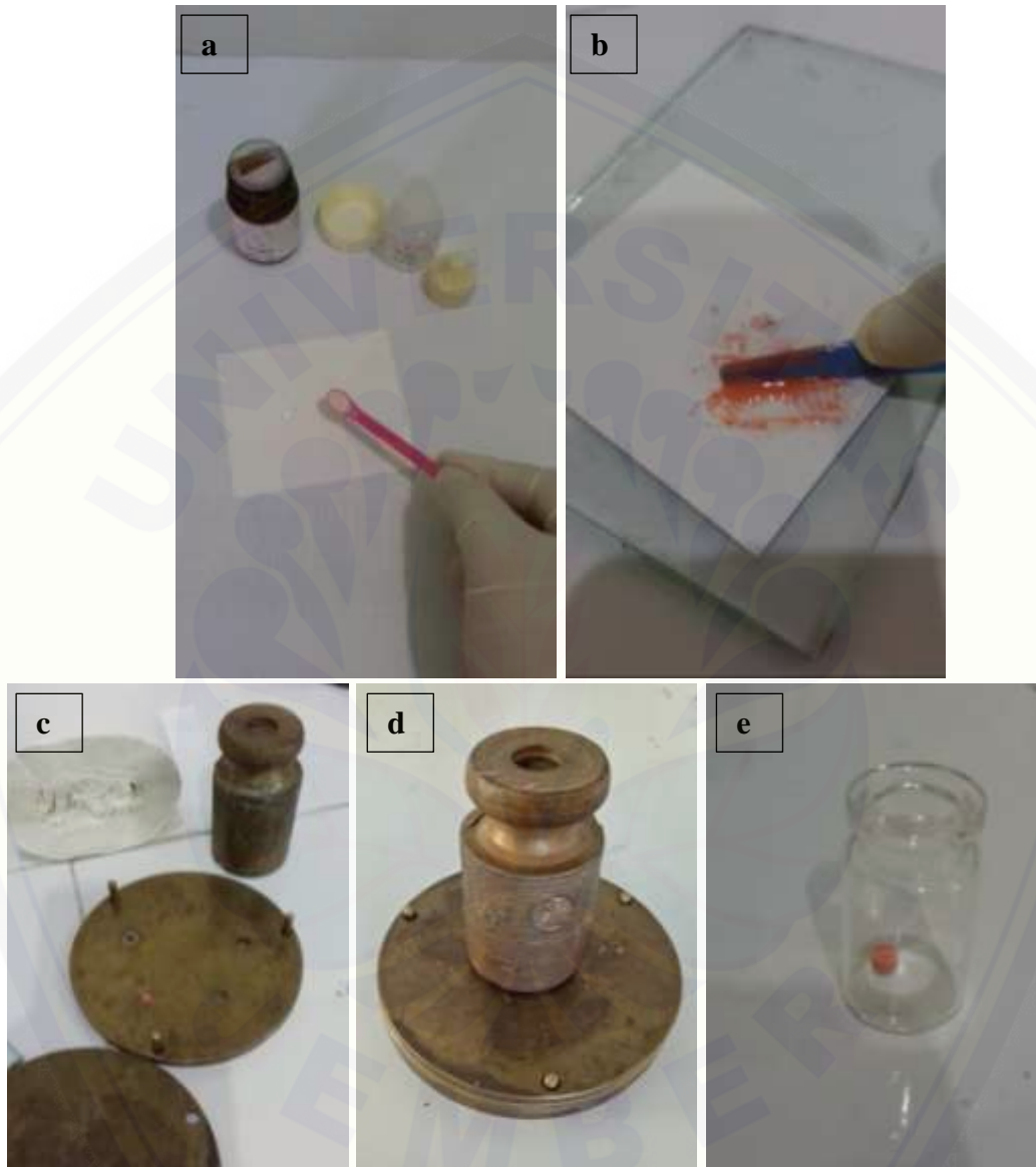
(a) Mengukur rasio bubuk dan cairan, (b) diaduk sampai homogen, (c) dimasukkan dalam cetakan cincin plastik, (d) ditekan dengan beban 0,5 kg, (e) ionomer kaca telah setting dimasukkan dalam pot obat.
