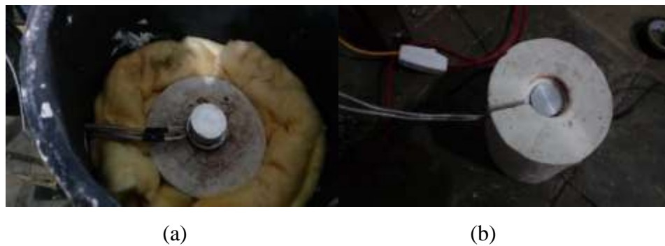
Gambar 4.2 (a), (b) pemasangan benda uji ke alat konduktivitas thermal
