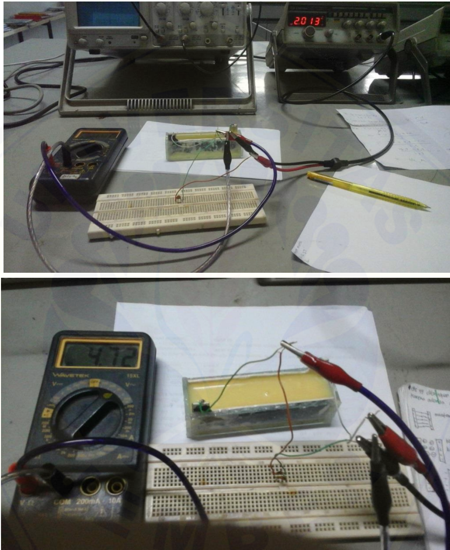
Gambar C.3 Pengukuran nilai konstanta dielektrik menggunakan voltmeter
