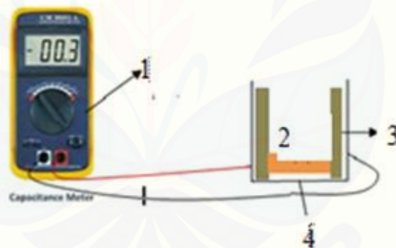
Gambar: 3.2 Skema pengukuran kapasitansi dengan kapasitansimeter
