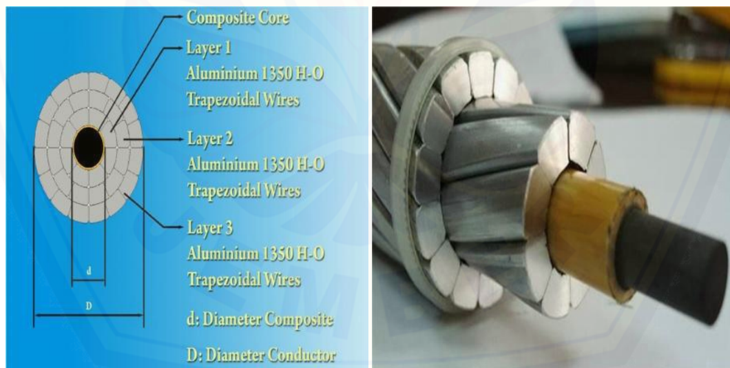
Gambar 2.4 Konduktor ACCC (Kurnaen,2014)
